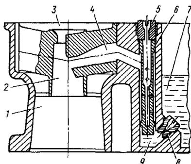
Рис. 6. Главная дозирующая система
