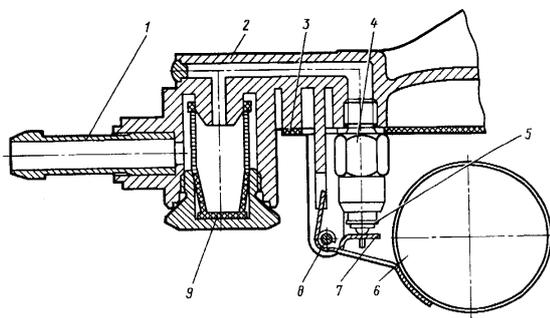
Рис. 37. Поплавковый механизм
