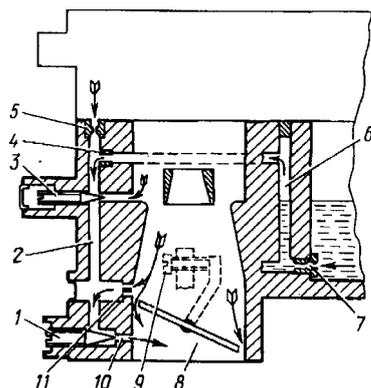
Рис. 11. Система холостого хода с задроссельным смесеобразованием
