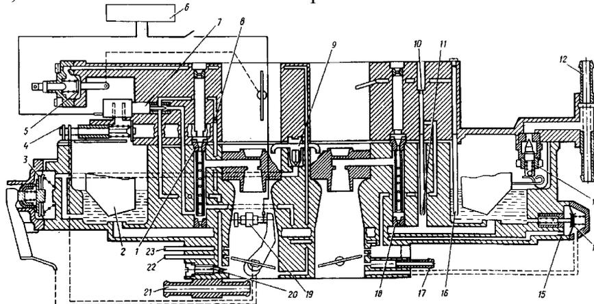
Рис. 40. Карбюратор ДААЗ-2108
