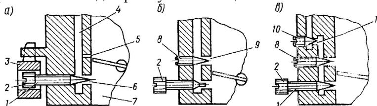
Рис. 10. Схема размещения регулировочных винтов карбюратора
