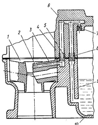
Рис. 24. Схема эконостата карбюратора ВАЗ-2105 и-2108
