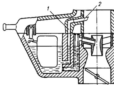
Рис. 21. Схема эконожата карбюратора ОАО "ПеКАР"
