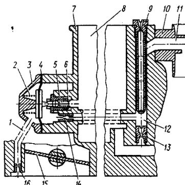
Рис. 18. Экономайзер мощностных режимов карбюраторов ВАЗ-2108 и -21081
