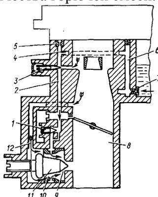
Рис. 13. Автономная система холостого хода
