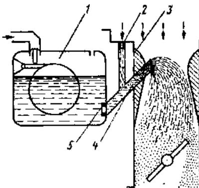
Рис. 5. Схема главного дозирующего устройства с пневматическим торможением топлива:
