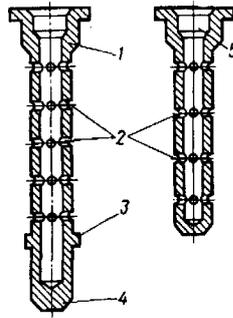
Рис. 8. Эмульсионная трубка
