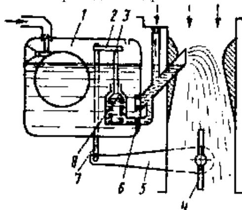
Рис. 16. Схема экономайзера с механическим приводом:
