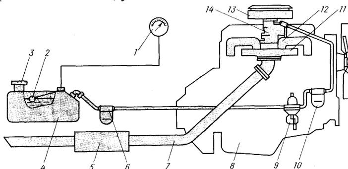
Рис. 1. Принципиальная схема системы питания карбюраторного двигателя:
