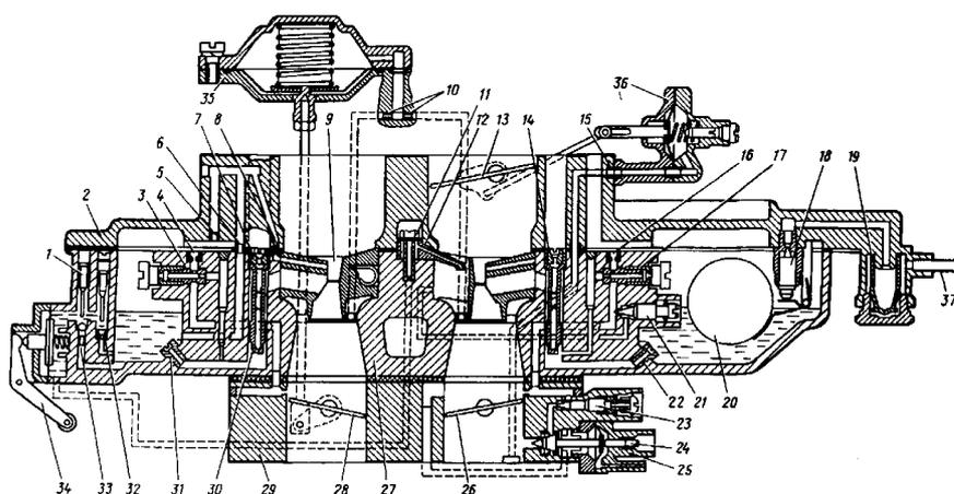
Рис. 39. Карбюратор ДААЗ-2105
