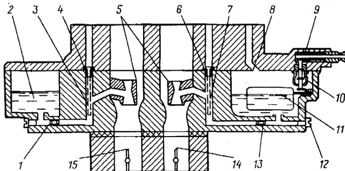
Рис. 7. Главная дозирующая система двухкамерных карбюраторов
