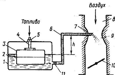
Рис. 2. Принципиальная схема простейшего карбюратора:
