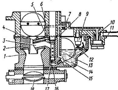
Рис. 23. Схема эконожата, совмещенного с ГДС
