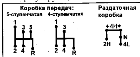
Рис. 12. Положения рычагов коробки переключения передач и раздаточной коробки: 1-5 -передачи; R -задний ход; 2Н - прямая передача, передний мост выключен; 4Н -прямая передача, включен передний мост (основное положение - правое); N -нейтральное положение; 4L -включен передний мост и понижающая передача
