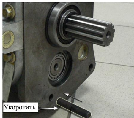
Рисунок 2. Доработка шпильки
