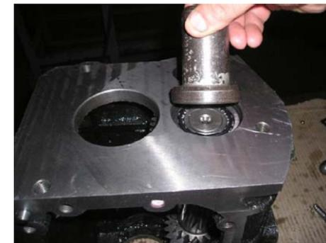
6) Определите расстояние (размер А) от внешнего торца подшипника до стопорного кольца с помощью измерительного прибора. Определите толщину стопорного кольца (размер В) с помощью штангенциркуля. Технические требования: размер А – размер В - (0,08-0,15) = размер прокладки С.
