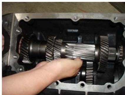
4) Установите две половины стопорного кольца шестерни пятой передачи, так чтобы оно было в канавке шестерни.
