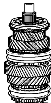
Рис. 6.29. Установка втулки подшипника 3 передачи
